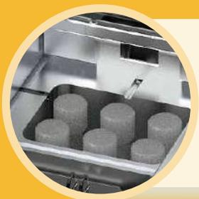
Cada dos cámaras cuenta con un compartimento de calentamiento para tubos, con capacidad de hasta 6 tubos de 5 ml o 14 ml.
